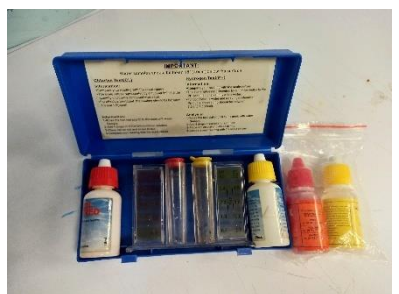
ชุดทดสอบค่า pH และ คลอรีน
